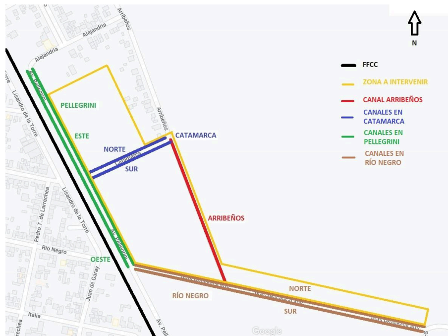
Figura 30 - Canales existentes en el sector a intervenir.
