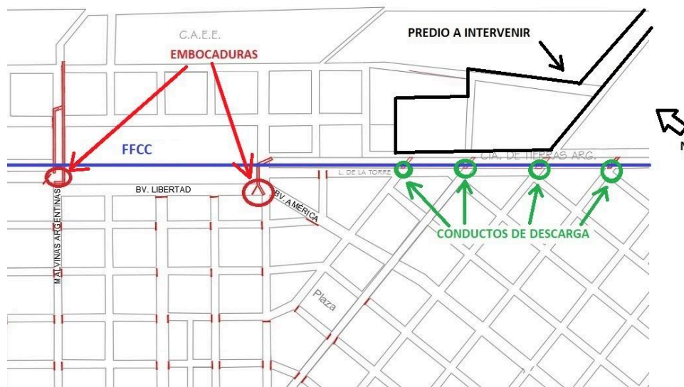
Figura 10 - Embocadura en ramales de desagüe pluvial.
