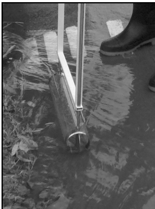
Figura 4. Muestreador DH3 (ARG-P-H-09).
