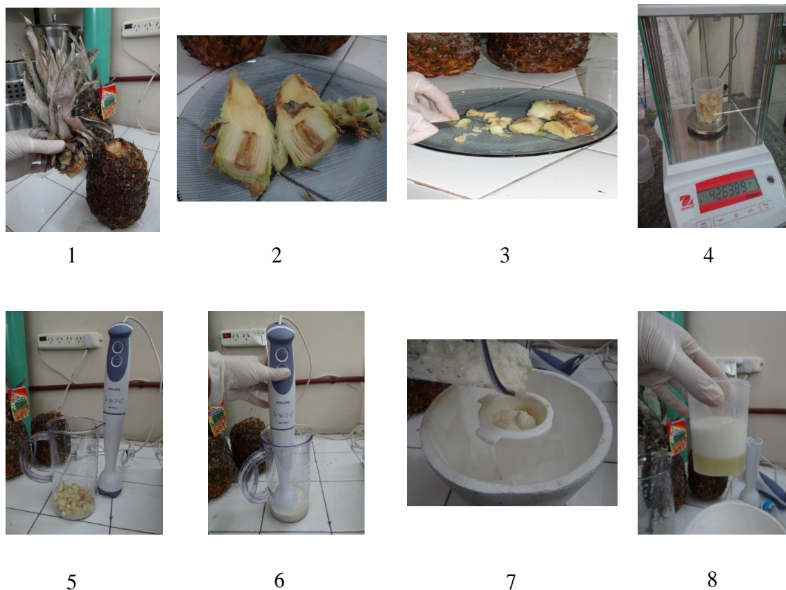
Figura 3.1: Preparación del extracto de tallo de ananá: (1) Separación del tallo del resto del ananá; (2) y (3) Corte del tallo en pequeños trozos; (4) Pesada; (5) y (6) Trituración con procesadora eléctrica en buffer Ac 100 mM pH 5,00; (7) Filtrado en tamiz; (8) Suspensión final, lista para dividir en alícuotas y conservar a -18 °C.
