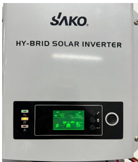
Figura 4.9 Inversor en operación alimentado desde panel fotovoltaico.
