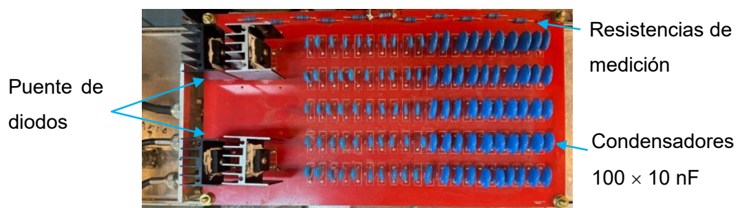
Figura 3.8 Banco de condensadores primarios ( C_1 ) con puente de diodos.
