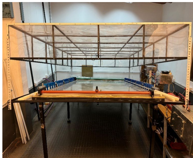
Figura 4.5 Cerramiento de seguridad del reactor en posición elevada.
