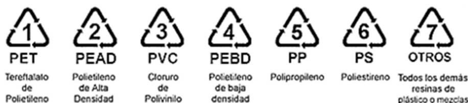
Figura 1. Símbolos dispuestos por la Norma IRAM 13700 para la identificación de resinas empleadas en la fabricación de objetos plásticos. Fuente: Página web CAIRPLAS.
