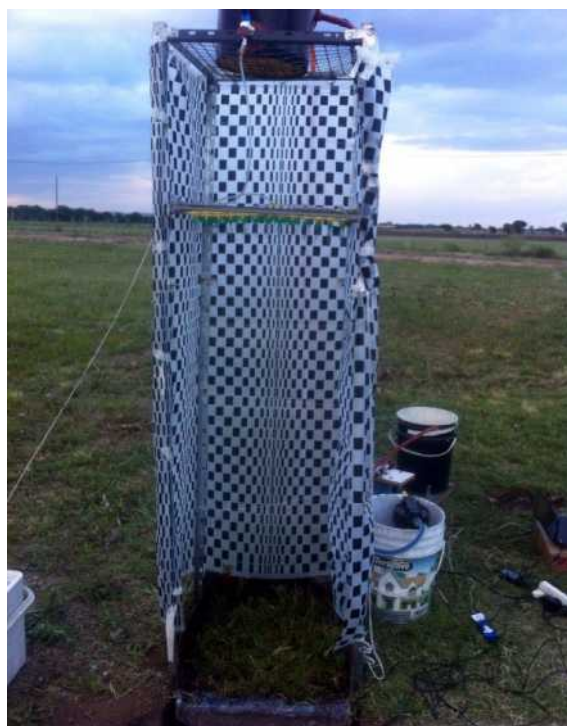
Figura 7. Simulador de lluvia con cortina cortavientos instalada.
