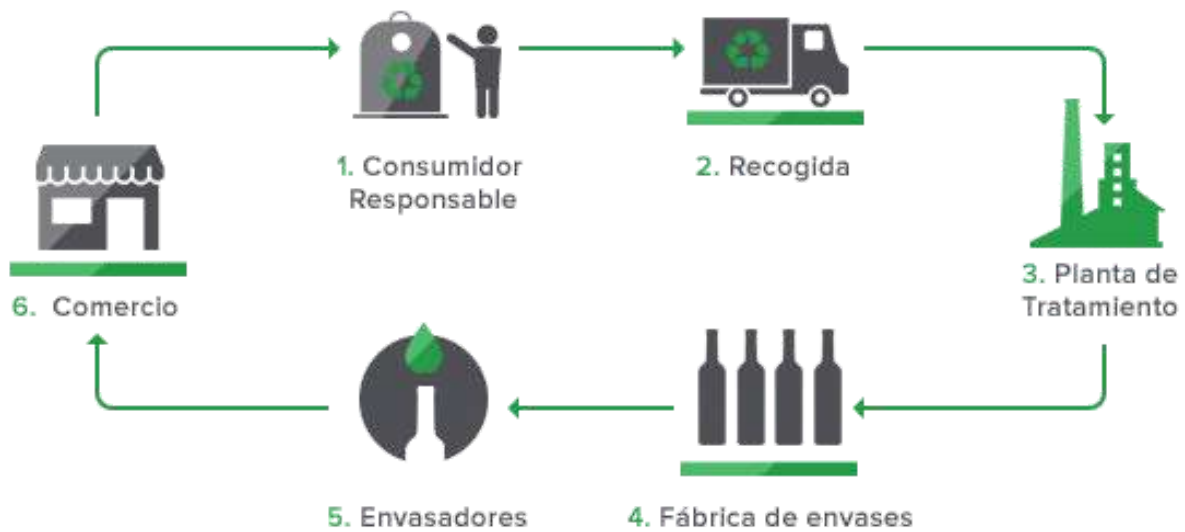
Figura 9: Esquema del reciclado de vidrio. Fuente: TMA Recicla 18 .
