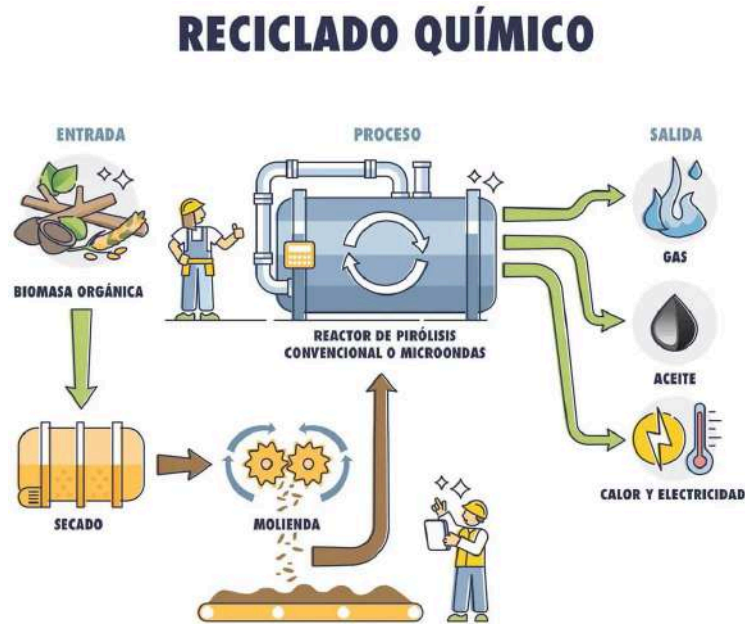
Figura 7: Proceso de reciclado químico de plásticos. Fuente: Knauf Industries.
