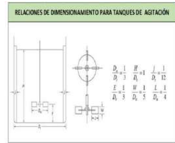
Relaciones de dimensionamiento para tanques de agitación.
