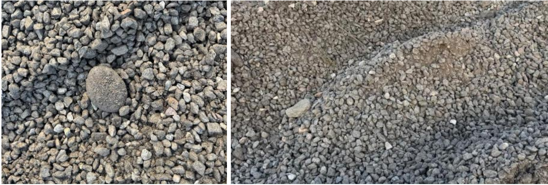
Figura 1-2: Ejemplo de material con variabilidad granulométrica dentro de una misma fracción comercial.
