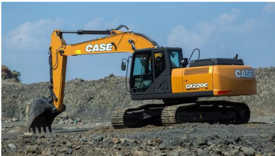
Figura 1-1: Excavadora hidráulica utilizada en operaciones de carga de áridos.
