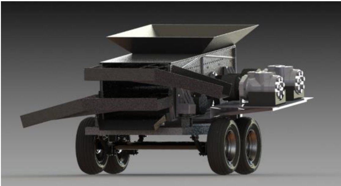
Figura 2-3: Vista general de la clasificadora móvil de áridos propuesta.
