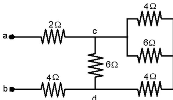
19) Calcule el valor de la tensión  $V_{ab}$  en los bornes de la siguiente red, de modo de que por la misma pueda circular una corriente total de 2 A. ¿Cuál es, en tales condiciones, la tensión entre los puntos c y d?
