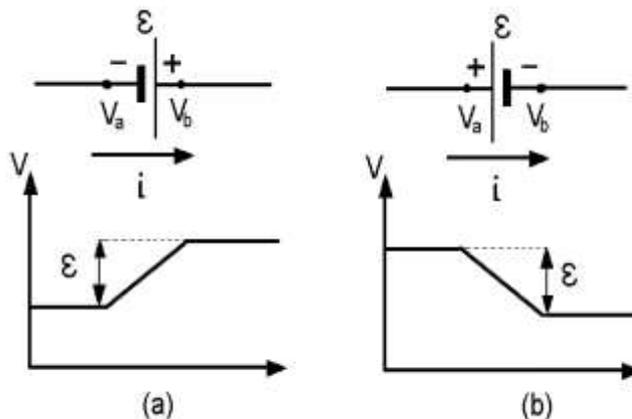
Ejemplos de aumento o caída de potencial según sea la circulación de corriente y la orientación de la fuente
