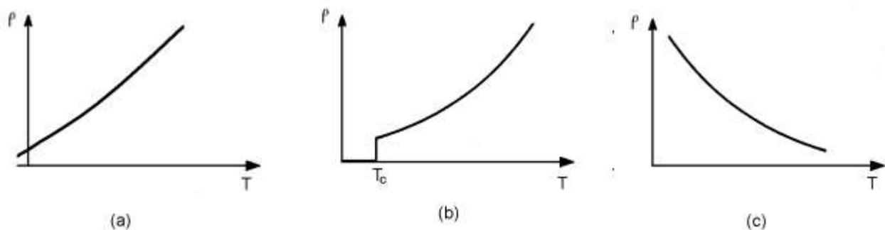
Variación de la resistividad de los materiales con la temperatura. En los conductores (a) el comportamiento es aproximadamente lineal, en los superconductores (b) cae bruscamente al alcanzar la temperatura crítica y en los semiconductores decae bruscamente al aumentar la temperatura.
