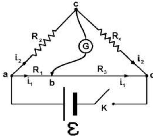
Si indicamos con  $L_1$  y  $L_2$  a los segmentos ab y bd, la resistencia desconocida  $R_x$  puede encontrarse como
