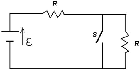
7-La batería que se muestra en la figura de este problema tiene una fem  $\epsilon$  y una resistencia interna  $r$ . Se encuentra conectada a un reóstato y a un interruptor **S** que puede abrir o cerrar el circuito. Entre las afirmaciones siguientes señala las que estén equivocadas.
