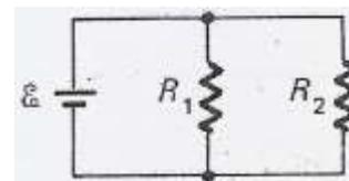
5-En las siguientes figuras a) y b) son iguales las fem de la batería, y los resistores tienen las mismas resistencias. La corriente en a) es  $I_a$ . La corriente en b) está dada por:
