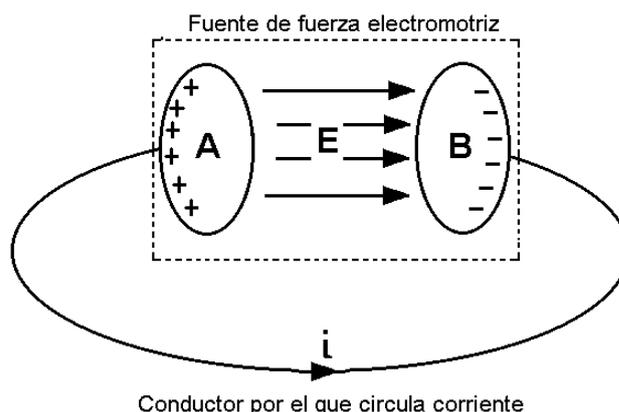
En las condiciones que establecimos este experimento imaginario la duración de la corriente será muy breve ya que cuando se equilibren los potenciales entre los cuerpos A y B cesará el movimiento de cargas y con ello la circulación de corriente.
