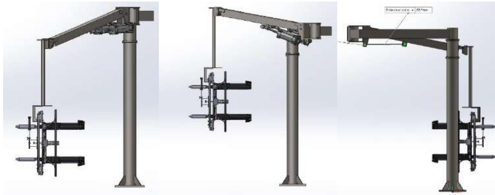
Figura 4-6: Posiciones límites y de guardado de brazo pivotante.
