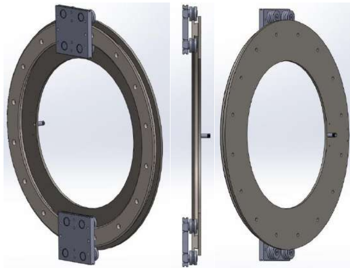
Figura 3-20: Bastidor y guía circular con patines.
