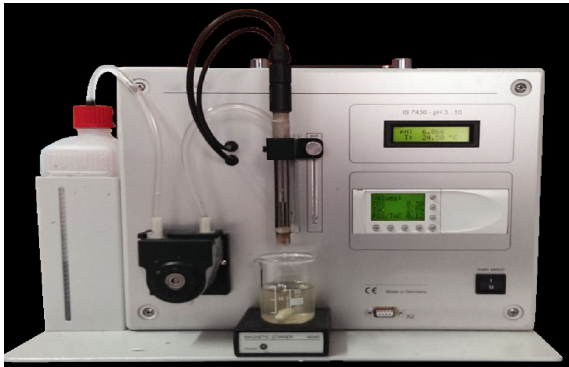
Fig.15:Equipo para medir la relación FOS/TAC
