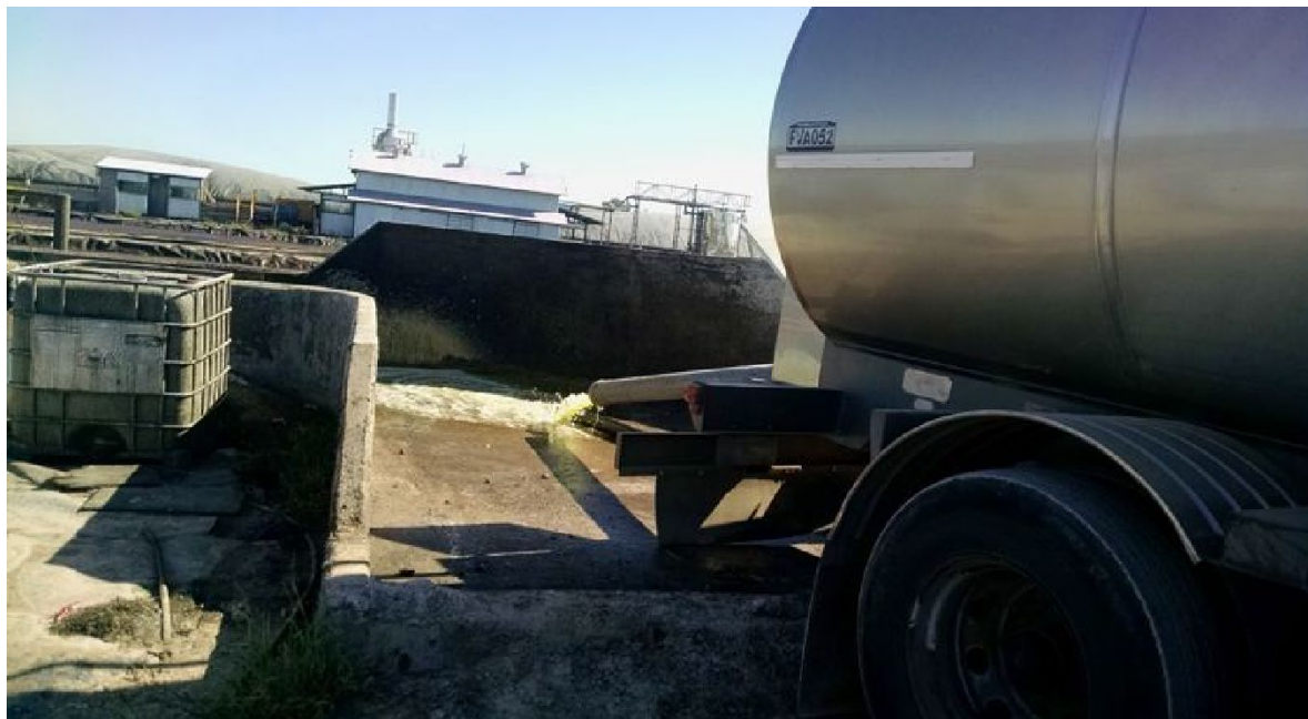
Fotografía 1: Descarga de efluentes provenientes de la industria láctea (permeado)
