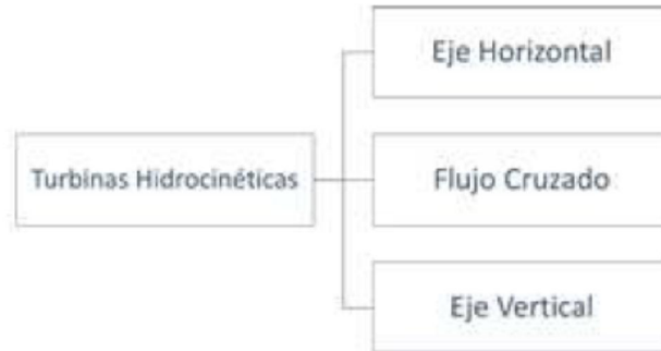
Figura 1.19 Clasificación de Rotores de Turbinas
