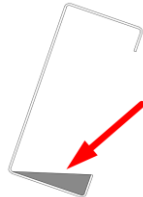
Acumulación de polvo en correas de cubierta
