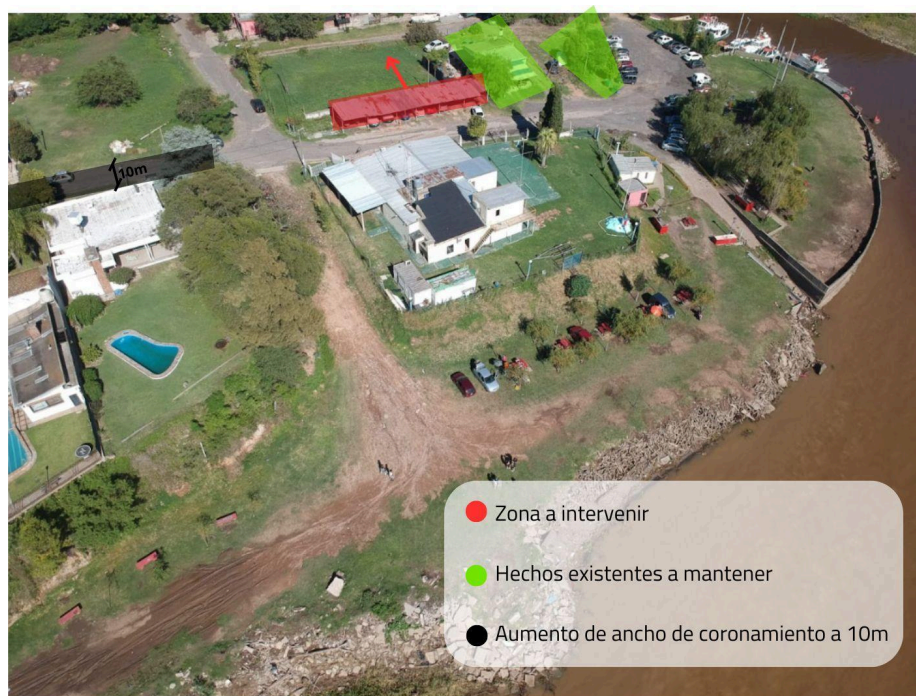
Imagen 15 - Esquema de adecuación del acceso de Bella Vista. Fuente: producción propia.
