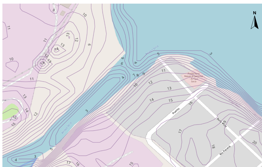
Imagen 10 - Curvas de nivel con sus valores de elevación en referencia IGN. Fuente: producción propia a partir de datos de imágenes satelitales.
