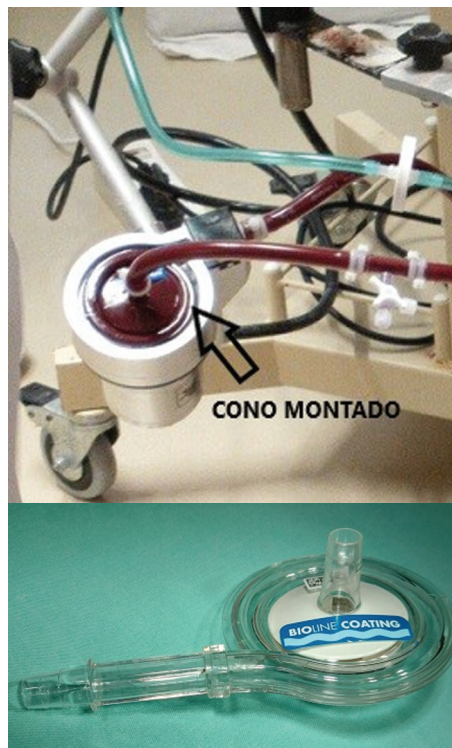
Figura 2. Bomba de rotación centrífuga con cono de succión montado (arriba), Cono de succión desmontado (abajo).
