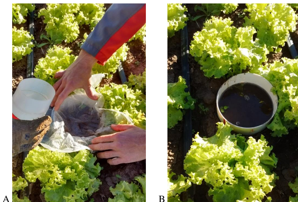
Figura 14. Colocación de la lámina de 25 mm de agua en el anillo de PVC (A) y medida del tiempo de infiltración (B)
