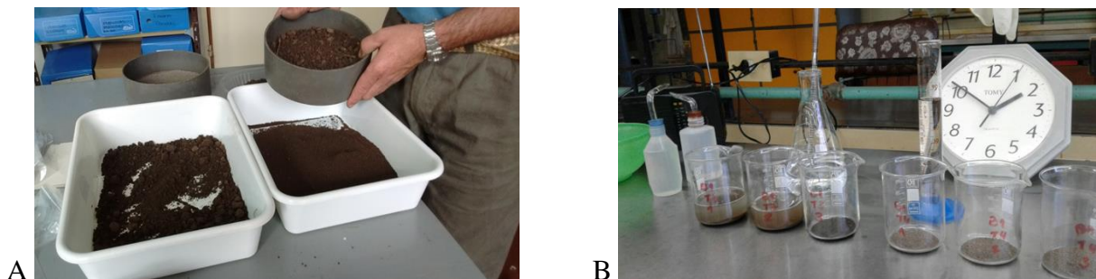
Figura 12. Tamizado de las muestras de suelo por malla de dos milímetros (A) y humectación de las mismas previa a la agitación mediante el aparato de Feodoroff
