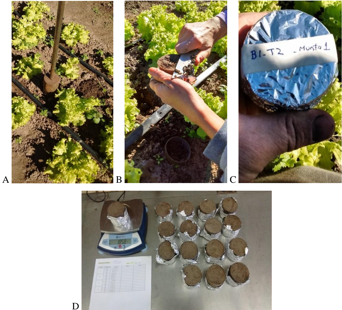
Figura 13. Introducción del muestreador de densidad en la platabanda (A), enrase de la muestra extraída (B), identificación y protección con papel de aluminio (C) y determinación del peso seco luego del secado en estufa, para los tratamientos evaluados
