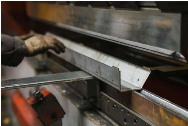
Fig.1-4: Proceso de plegado de chapas.
