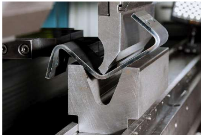
Fig. 2-5: Plegado al aire con matriz en V.
