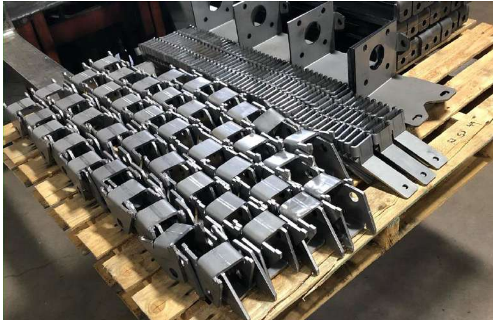
Fig. 1-2 Piezas cortadas a láser CNC y plegadas, listas para producción.
