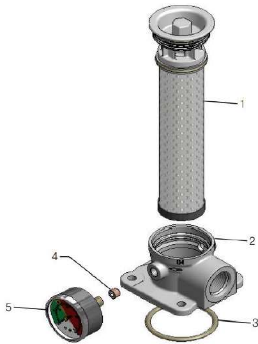
Fig. 5-10D. espiece y partes del filtro de retorno serie "tanktop" del fabricante PARKER.
