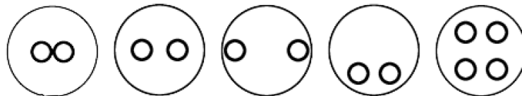
Figura 41 – Vista de sección transversal de configuraciones de cañerías dentro de un borehole. Fuente: ASHRAE (2015).
