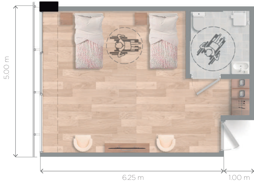
Imagen: Habitación de emergencia (izquierda) y unidad de habitación adaptada (derecha).. Fuente: Autoría Propia.
