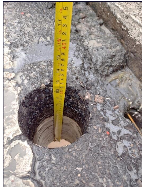
Imagen N° 2.2.2. Perforación realizada en puente. Muestra obtenida.
