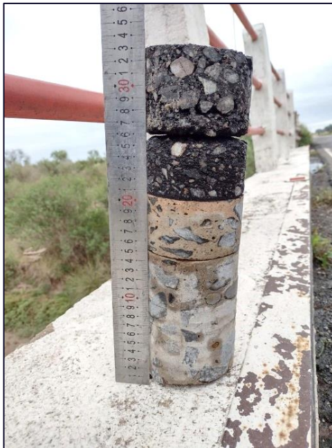
Imagen N° 2.2.2. Perforación realizada en puente. Muestra obtenida.
