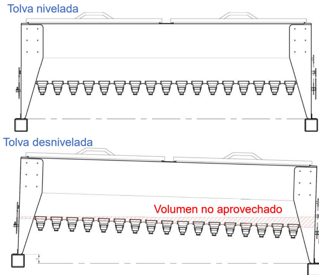
Figura 1-3: Diferencia entre tolva nivelada y desnivelada
