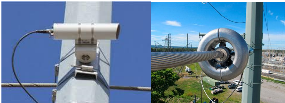
Figura 3-1: Métodos de medición directos (Medición de flecha y de temperatura superficial del conductor)
