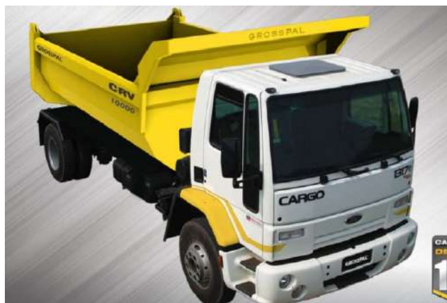
Figura N° 16: Camión volcador de 10 m 3 de capacidad (Fuente: Google Imágenes)
