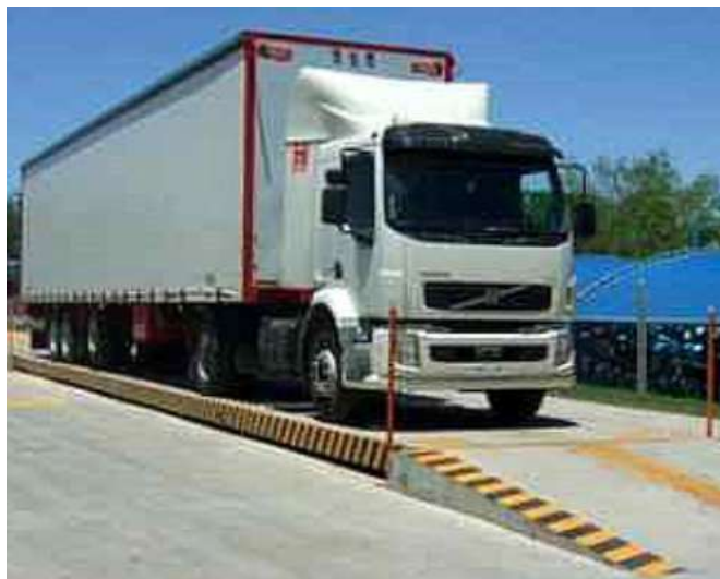
Figura A5.2: Balanza para camiones recolectores “Moretti 7500”. Fuente: Google imágenes.
