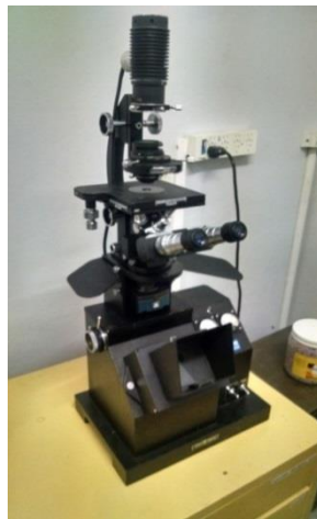
Figura 3.6: Microscopio óptico invertido acoplado a cámara digital
