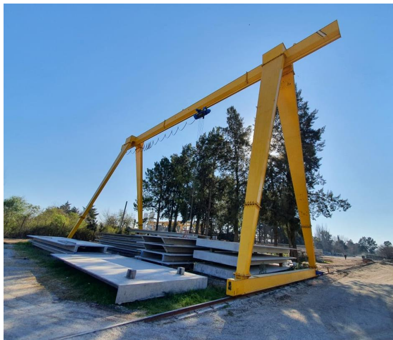
Figuras 120b: Acopio de premoldeados bajo pórticos grúa (TENSAR SA)
