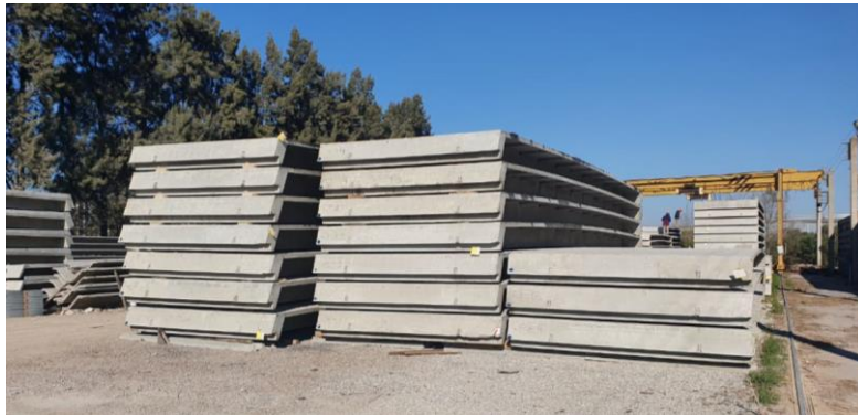
Figuras 120a: Acopio de premoldeados bajo pórticos grúa (TENSAR SA)
