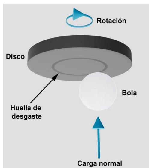
Figura 3.17. Representación esquemática del ensayo ball-on-disc .
