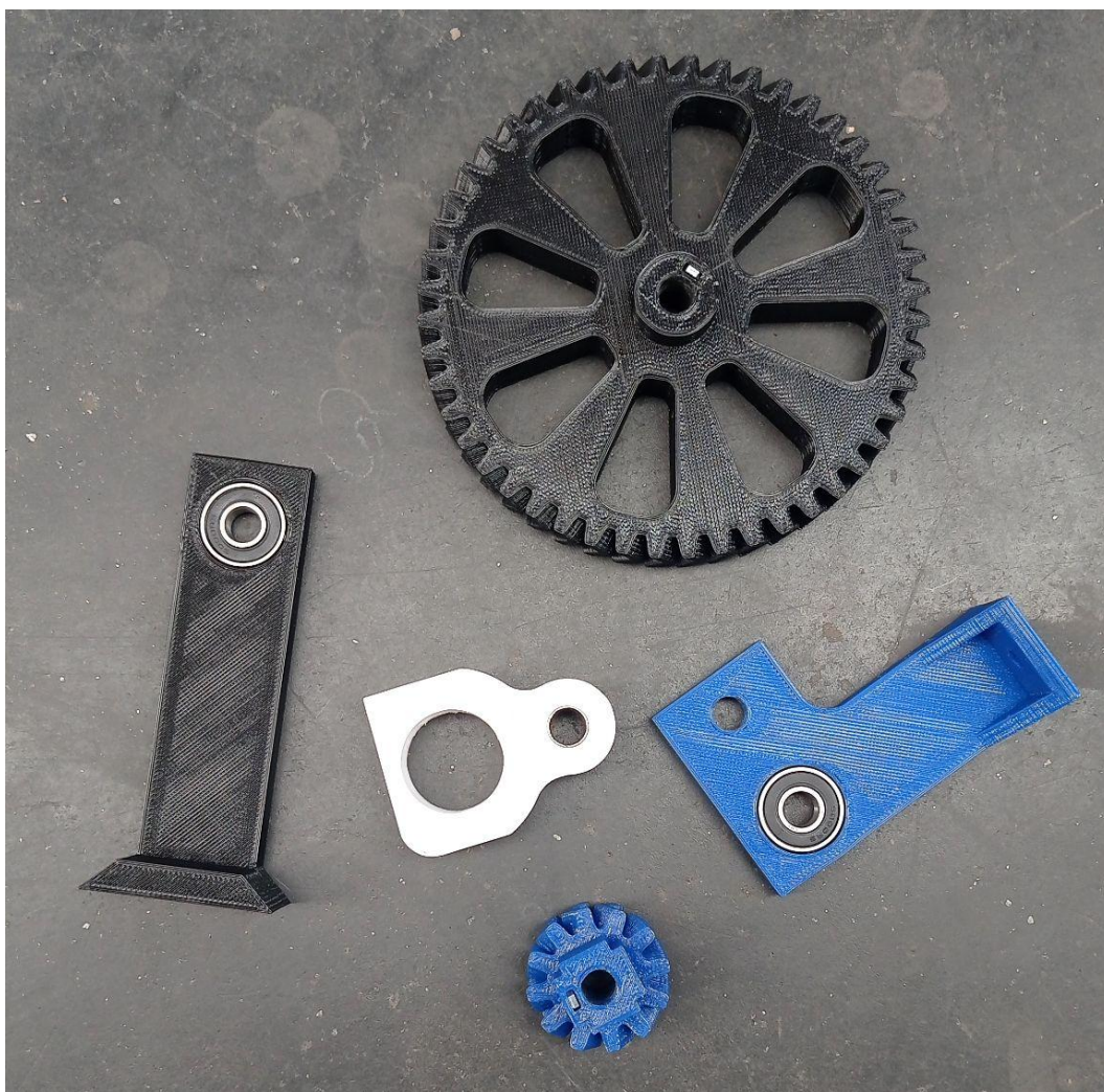
Fig. 18: Instalación de rodamientos y tuercas con aire caliente
