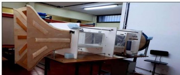
Sección de prueba 30 x 28 cm Motor eléctrico de 1 HP
