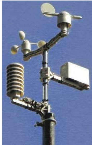
Figura 13: Estación meteorológica con anemómetro de coperolas y veleta (FCEIA – UNR). Elaboración propia.
