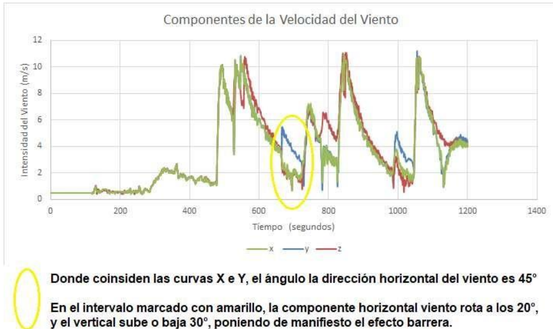
Figura 108: Registro de las 3 componentes del viento durante 20 minutos. Fuente propia, construida con los datos obtenidos del anemómetro 3D desarrollado en esta tesis.
