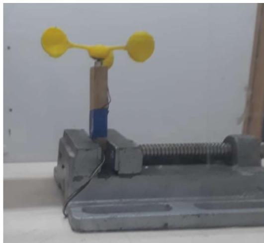
Figura 69: Construcción del primer anemómetro del proyecto. Elaboración propia.
