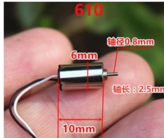
Figura 68: Motor seleccionado para este proyecto como transductor. Fuente: ELEC & lifes Store
