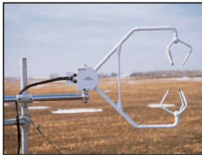
Figura 14: Anemómetro sónico tridimensional. Fuente: [20].
