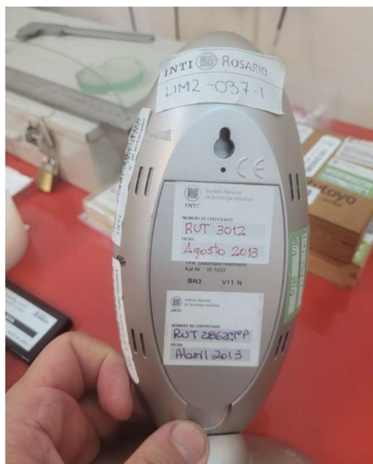
Figura 103: Estación Meteorológica TFA (Origen Alemania) Etiquetas de calibración primaria. Fuente: INTI.
