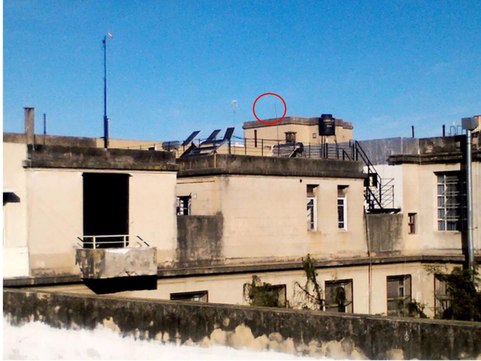
Azotea del Laboratorio de Energías Renovables de la UNR, donde en el círculo rojo se indica la veleta y el anemómetro de la estación meteorológica. [4]
