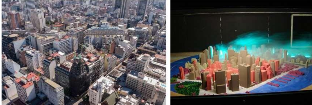
Figura 6: Izquierda: ejemplo de ciudad altamente edificada. Derecha: ensayo en túnel de viento de los flujos que se desarrollan en ella. Fuente: [14].
