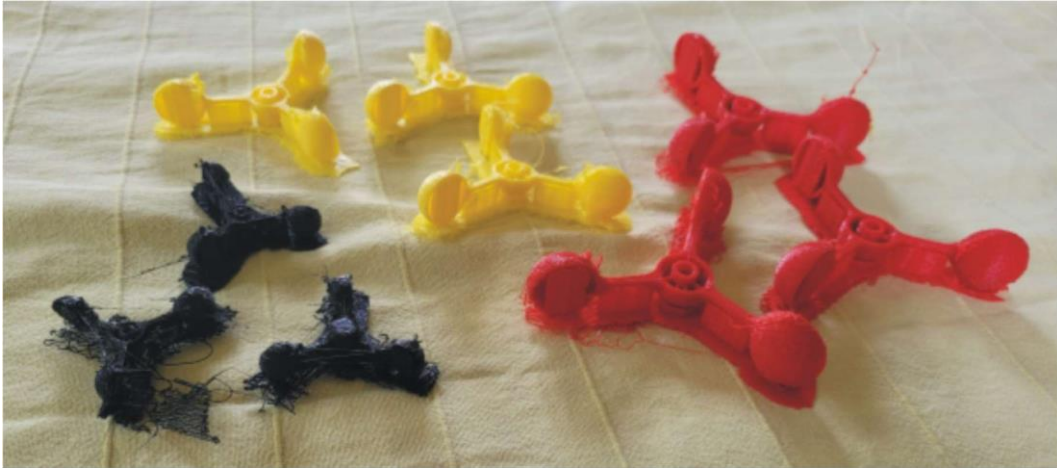
Figura 65: Conjunto de piezas 3D para ensayos en túnel de viento antes de su limpieza final (Se aprecia la diferencia de tamaño entre los diferentes juegos impresos). Elaboración propia.
