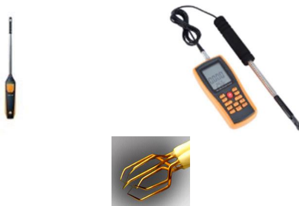
Figura 16: Termo anemómetros. Arriba unidireccional – abajo tridimensional Fuente: [20].
