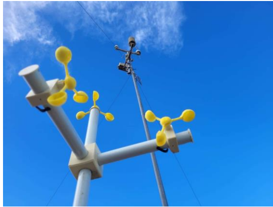
Figura 104: Vista del anemómetro 3D de coperoles diseñado, desarrollado y testado. Elaboración propia.
