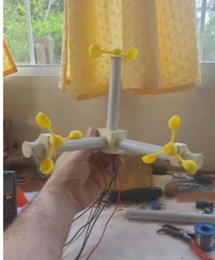
Figura 84: Montaje mecánico del anemómetro 3D de coperolas. Elaboración propia.
