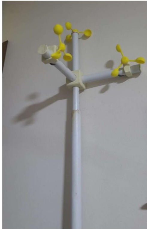
Figura 97: Anemómetro 3D terminado. Elaboración propia.
