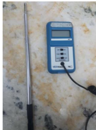
Figura 72: Anemómetro de hilo caliente empleado en las mediciones en Neuquén. Fuente: Universidad Nacional del Comahue.
