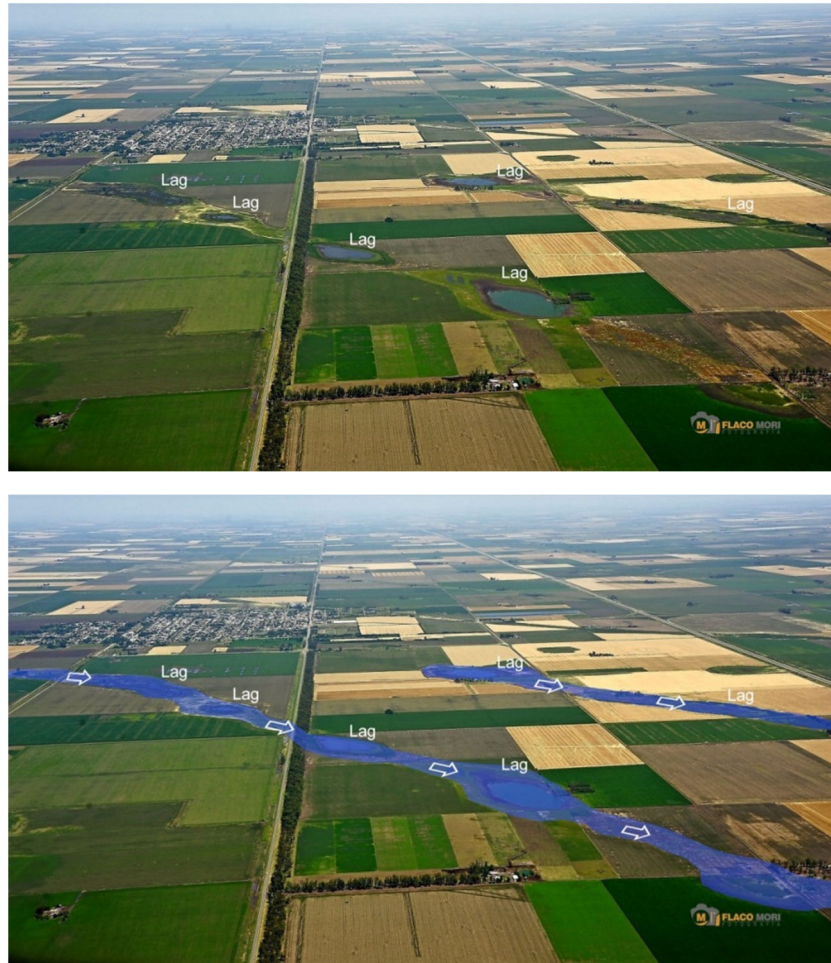
Figura 6.17 – En la foto superior pueden observarse las lagunas alineadas y aisladas que en eventos lluviosos se conectan entre sí originando líneas de flujo longitudinales en dirección y sentido SO-NE, como se observa en la foto inferior a través de las flechas. (Fuente: www.flickr.com , fotógrafo: F. Mori®).
