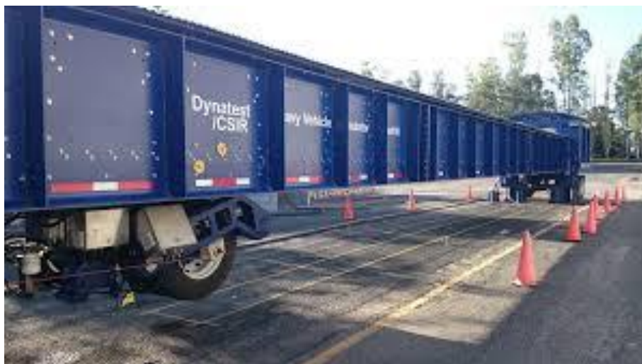
Imagen n° 24: Simulador de carga pesada utilizada por el Instituto Mexicano de Transporte.
