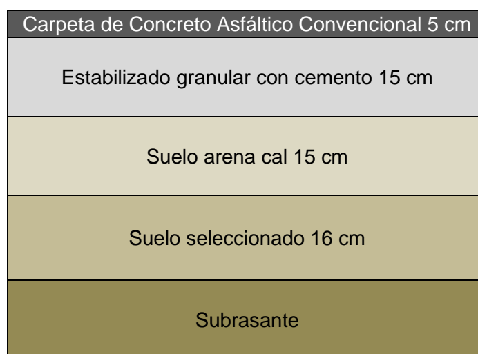
Imagen nº 49: Esquema paquete estructural RP22-s (Km 0+200 – 10+900).
