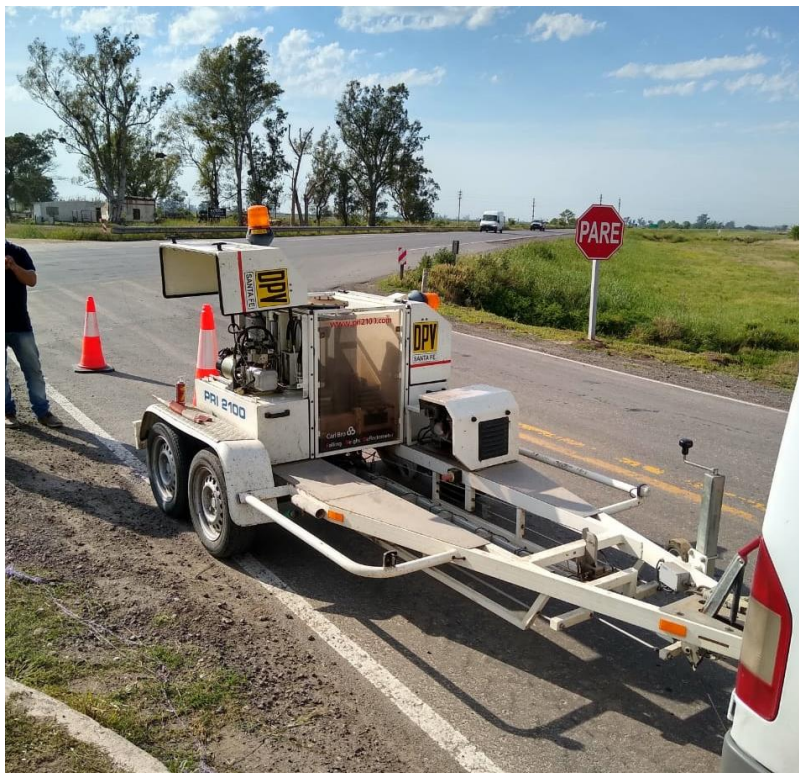
Imagen n° 28: Equipo deflectómetro perteneciente a la Dirección de Vialidad Provincial, con el que se evaluaron algunos de los tramos mencionados.
