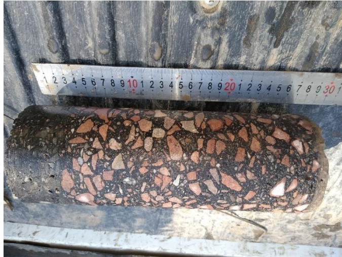
Imagen n° 30: Determinación de capas y espesor en un testigo calado.
