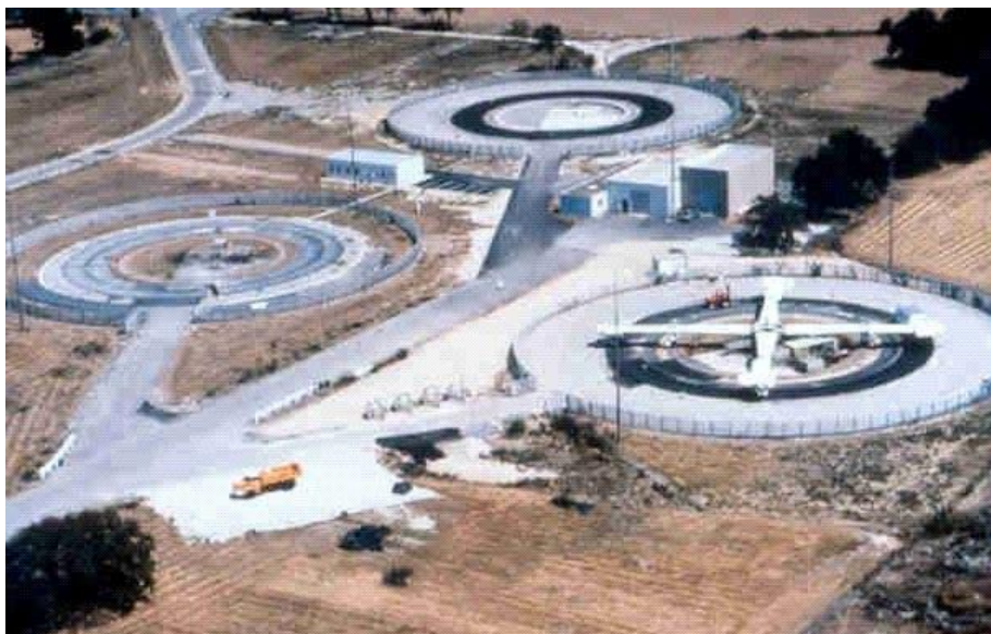
Imagen n° 23: Pistas de prueba a escala real tipo carrusel, entraron en funcionamiento en 1984 en Nantes (Francia).
