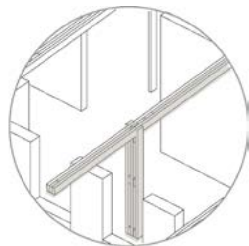
DOBLE VIGA CON COLUMNAS TRIPLES
