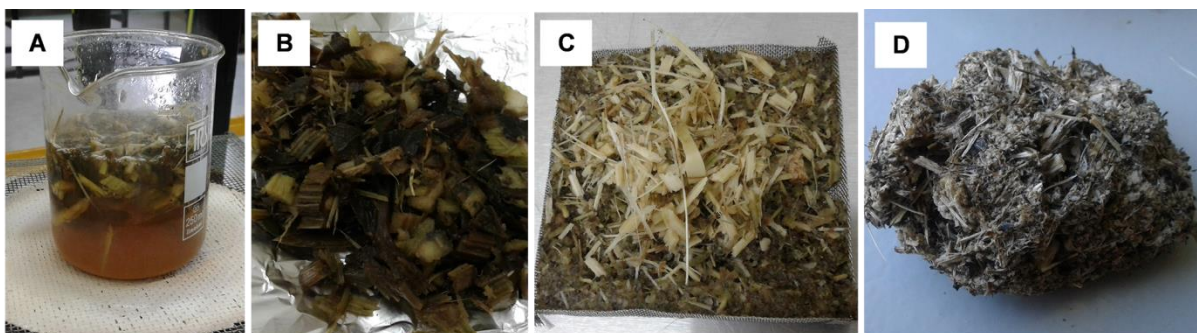
Figura 97: Proceso de extracción de fibra insoluble total en planta entera. Tratamiento con calor (A); escurrido (B); procesado, lavado y filtrado (C); material secado en estufa (D).
