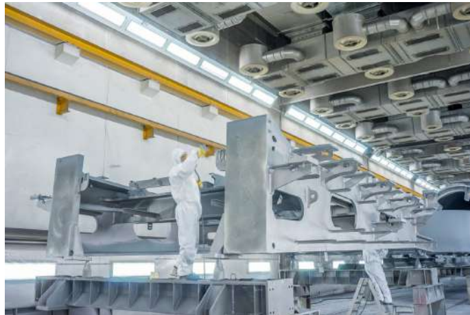
Figura 3.6: Proceso de recubrimiento anticorrosión de la viga cajón en taller [28]
