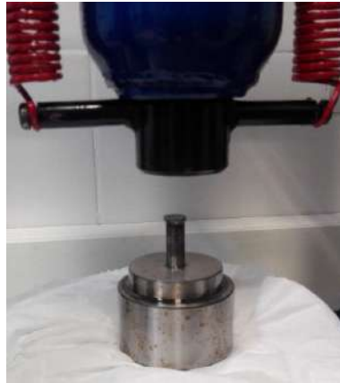
FIGURA 2.2: Prensa uniaxial con matriz de 10mm para el prensado de polvos.
