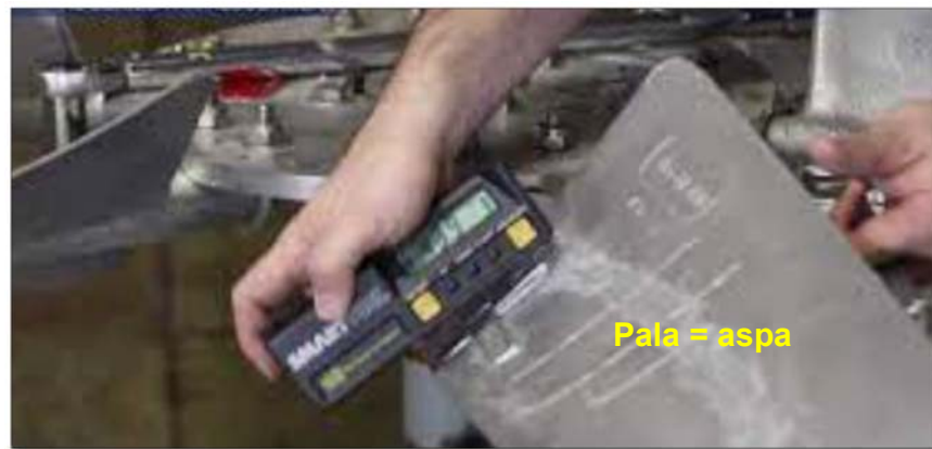
Imagen 1-5: Ajuste manual de ángulo de pala con goniómetro 7 digital.
