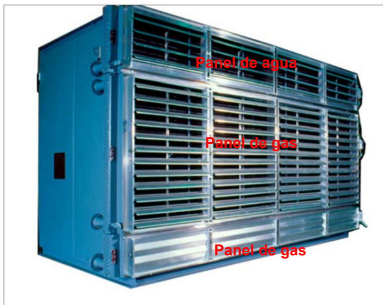
Imagen 1-2: Vista de un Aeroenfriador genérico.
