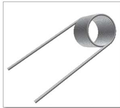
Imagen 5-21: Muelle (resorte) de torsión. Fuente: thespringstore.com
