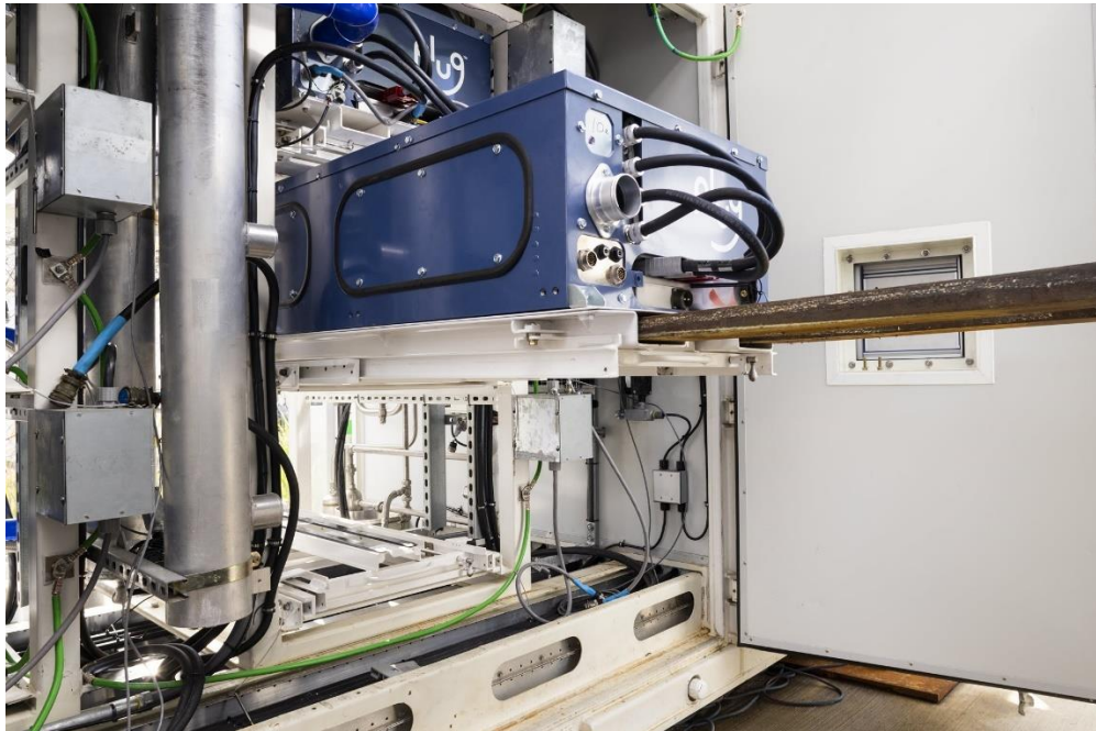
Figura 5-92: Apilamiento de celda de combustible.
