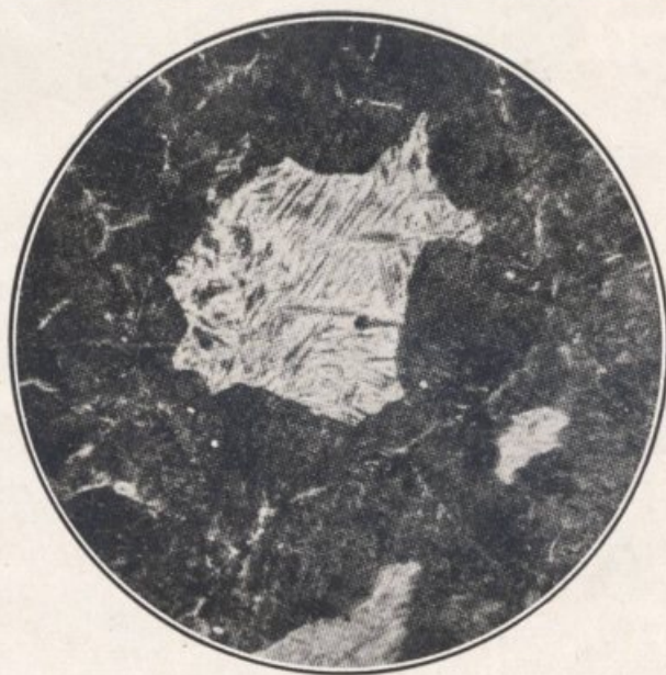
Fig. 3. — Micrografía mostrando un grano de martensita en una placa de acero al carbón en la vecindad de la soldadura ejecutada en una sola pasada. Aumento: 250. Ataque: ácido pícrico
