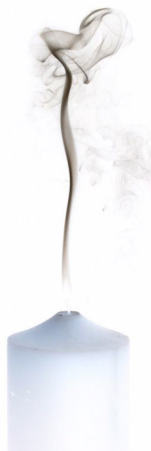
Figura 2.1: El flujo del humo que sale de una vela es laminar al comienzo y luego se vuelve turbulento
