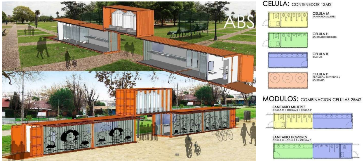
Figura 7.7 - Esquema del sistema BA.CO.
