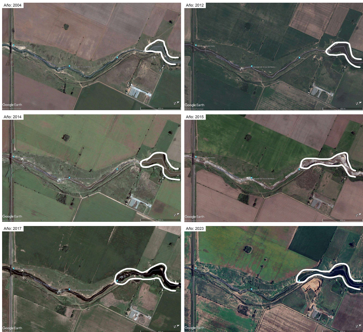
Figura 4.2 - Variaciones en la morfología del Arroyo del Medio y evolución en el tiempo del efecto retrogradante de La Olla. Fuente: Google Earth.
