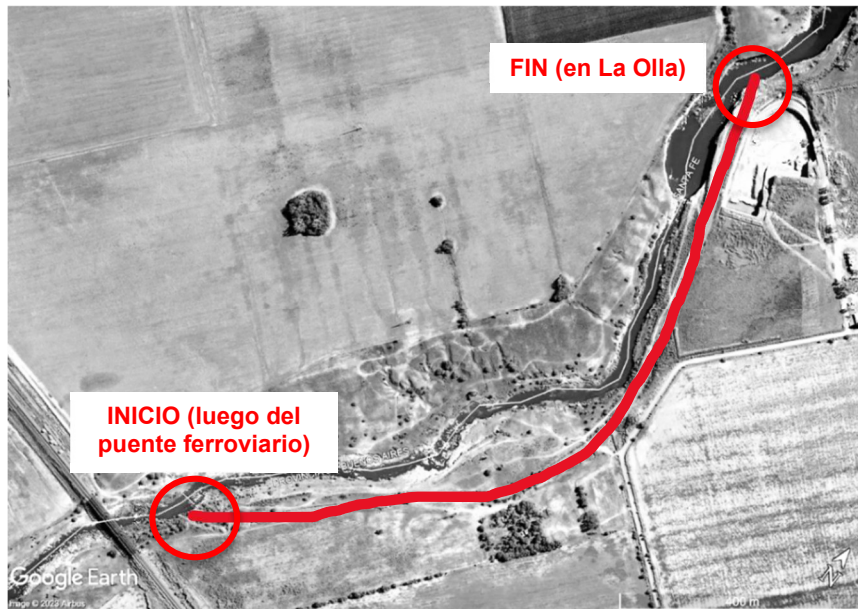
Figura 5.22 - Recorrido y extensión del canal de derivación, paralelo al Arroyo del Medio.
