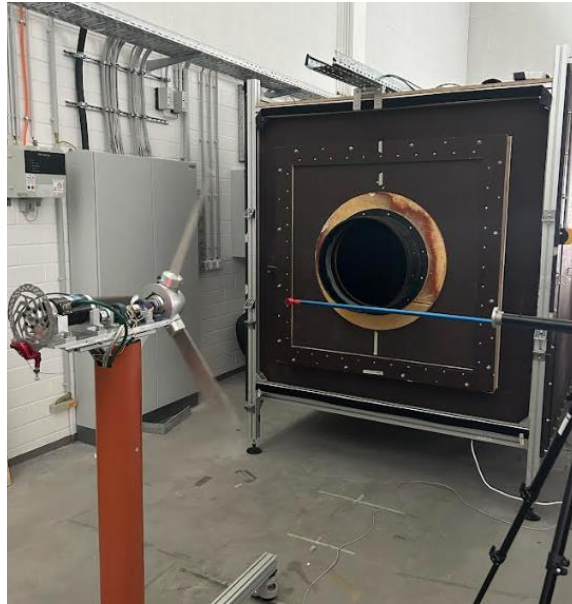
Figura 5-1 – Testeo del aerogenerador en tunel de viento
