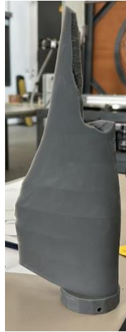
Figura 3-13 – intento fallido de impresión del aspa
