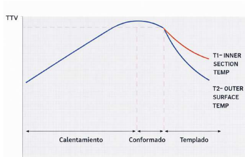
Figura 3-2: Evolución térmica de temperatura en la placa de vidrio durante el templado por chorro de aire.
