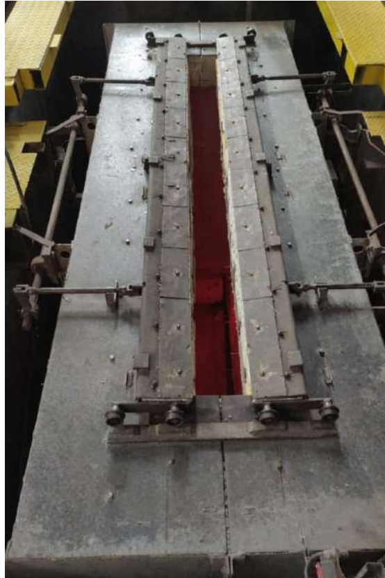
Figura 1-3: Cámara de calentamiento de vidrio plano.
