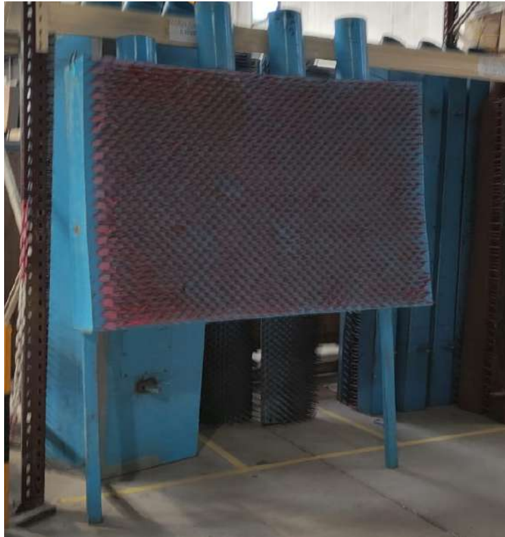
Figura 2-6: Módulo para vidrio de doble curvatura.
