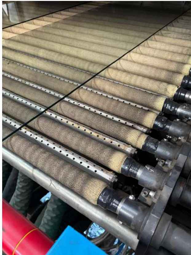
Figura 5-8: Salidas de aire del Horno Horizontal.
