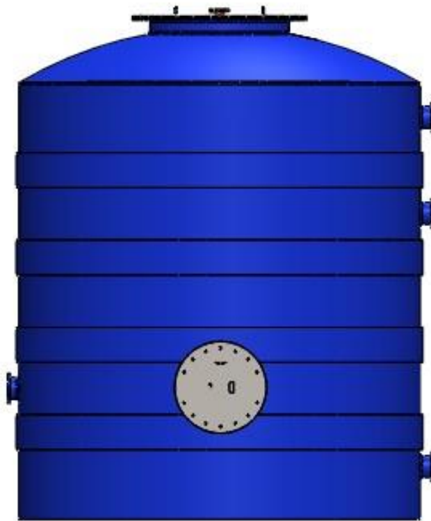
Figura 4-5: Tanque de almacenamiento con brida de ingreso, egreso, para colocación de intercambiador de calor y soporte de sensores, elaboración propia.
