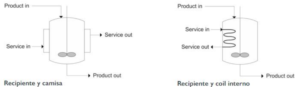
Figura 3-7: Concepto de intercambiadores internos [1]
