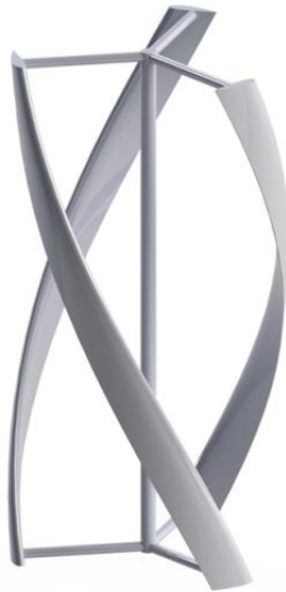
Figura 1-8: Esquema de los álabes helicoidales de una turbina Gorlov [4]:
