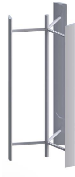
Figura 1-5: Esquema de los álabes rectos de una turbina Darrieus [4]:
