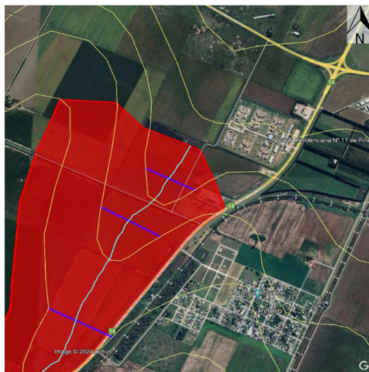
Imagen 48: Secciones analizadas para determinar el área de inundación.
