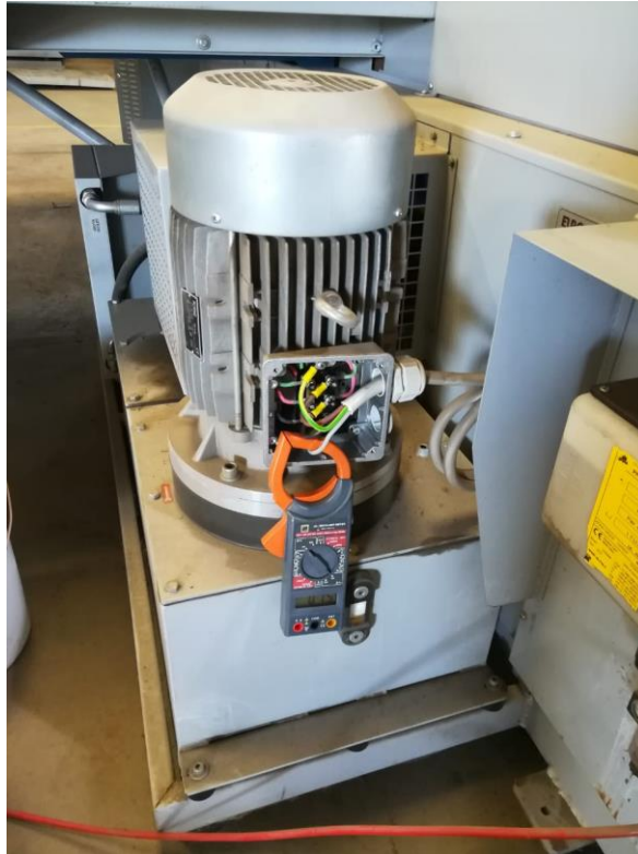
Figura 7.4.2: Ejemplo de medición en caja de conexiones.
