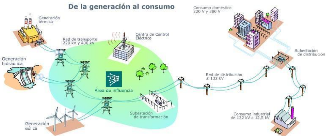
Figura 6.3.1: Ilustración básica de un sistema eléctrico.
