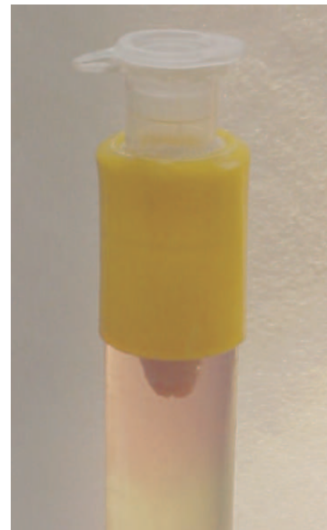
Fig. 3. Dispositivo para evaluar filtraciones
