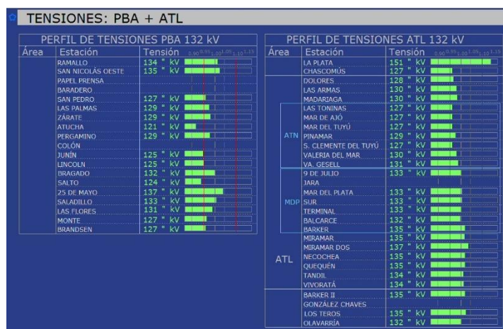
Figura 9-46: Tensiones PBA y ATL- incorporación de generación forzada en Lincoln.
