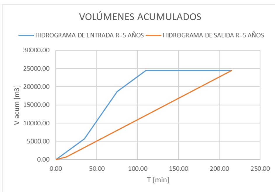
Figura 11.3-T: Volúmenes acumulados de Entrada y Salida - Comportamiento del conjunto Reservoirio-Orificios - R 5 años. Fuente: Elaboración propia.
