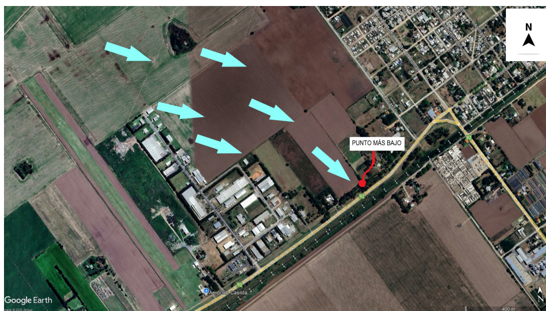
Imagen 10: Esguimiento superficial actual de la zona de estudio. Fuente: elaboración propia.
