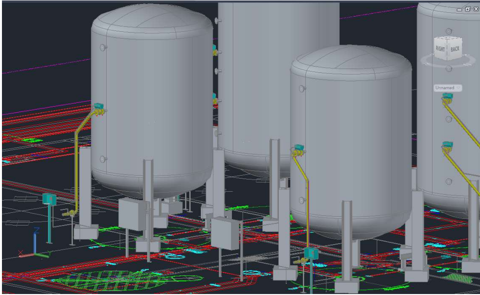
Figura 3-5: Vista de la disposición simétrica de bajadas de tanques de Catién [12].
